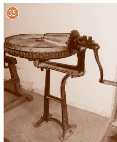
27. Tina circular de pasteurización. 28. Lira para corte y palas de batido. 29. Tina cuadrada, lira y palas de batido. 30. Prensado individual con pesas de cemento. 31. Prensado en conjunto, prensa de tornillo. 32. Andamio en cámara de maduración. 33. Descremadora manual con adaptación de motor eléctrico. 34. Batidora de tambor para mantequilla. 35. Amasadora para mantequilla.
